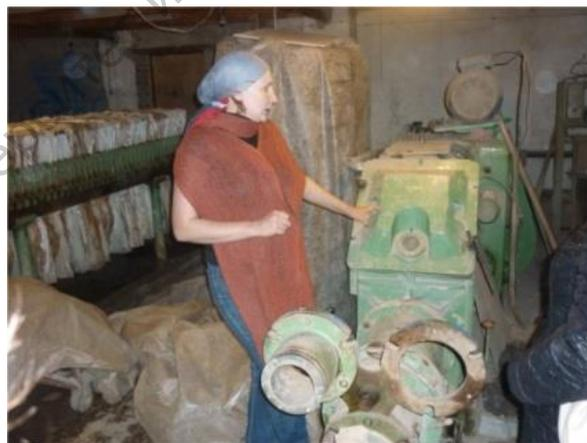
Рис. 2. Цех для создания «полуфабрикатов» глины из порошка
