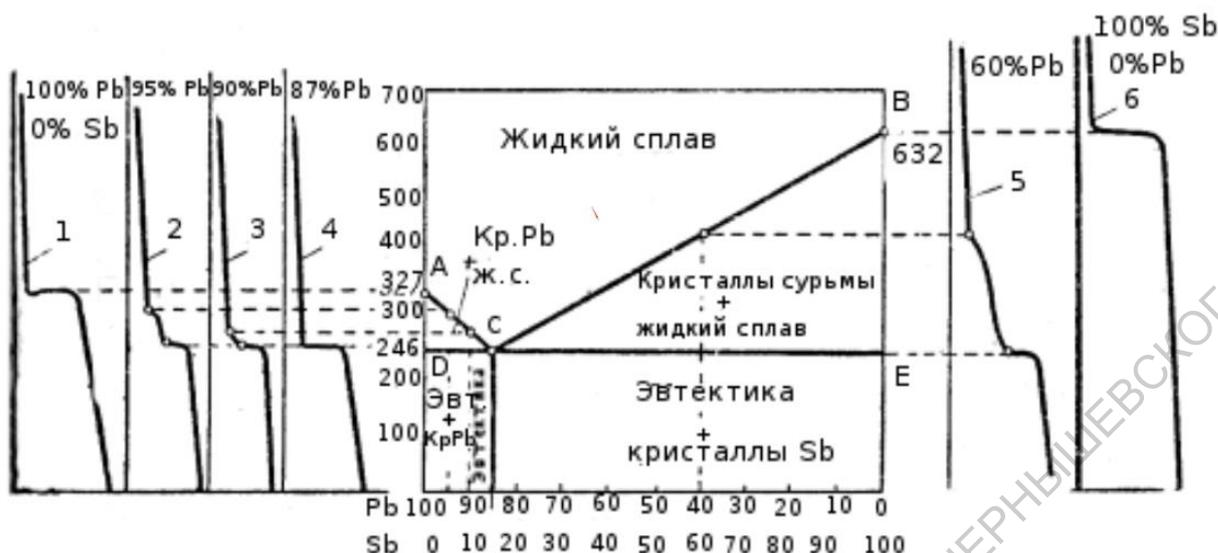
Рис. 4. Диаграмма состояния сплава свинец — сурьма, построенная по кривым охлаждения
