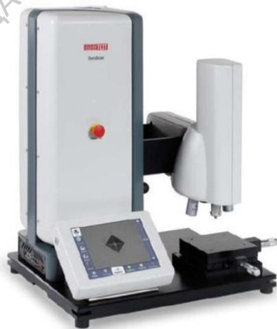
Рис. 1. Микротвердомер DuraScan 20
