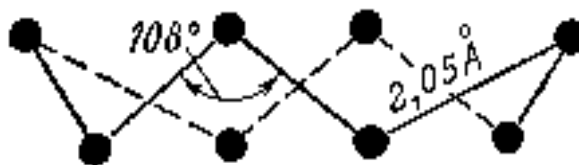
Рис. 1. Циклическое строение молекулы серы
