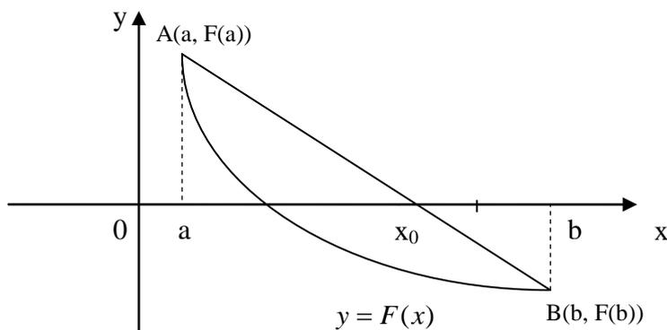
Пусть найден отрезок  $[a, b]$ , где уравнение  $F(x) = 0$  имеет корень. Для определенности будем считать, что  $F(a) > 0$ , а  $F(b) < 0$ . В данном методе процесс итераций состоит в том, что в качестве приближений к корню уравнения (1.1) принимаются значения  $x_0, x_1, x_2, \dots, x_n, \dots$  точек пересечения хорды с осью абсцисс.
