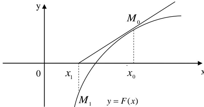
Этот метод в отличие от метода хорд на  $k$ -ой итерации вместо построения хорды требует построить касательную к кривой  $y = F(x)$  при  $x = x_k$ , при этом за следующее приближение  $x_{k+1}$  принимается точка пересечения этой касательной с осью  $Ox$ . Пользуясь этим методом не обязательно знать отрезок  $[a, b]$ , где содержится корень уравнения  $F(x) = 0$ , а достаточно лишь найти некоторое начальное приближение к корню  $x = x_0$ .
