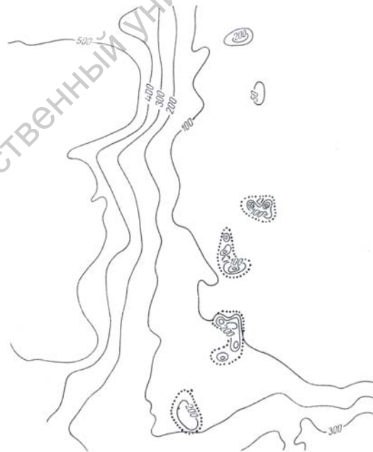
Рис. 5.7. План изодинам \Delta Z (в гаммах) над бокситовыми залежами платформенного типа в зоне контакта порфиров и известняков (по А.А.Логачеву). (точеной кривой показаны контуры бокситовых тел по пазведочным данным).
