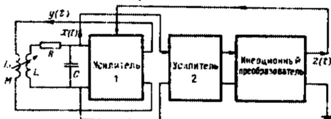
Рис. 7.4. Модифицированная схема генератора с инерционной нелинейностью
