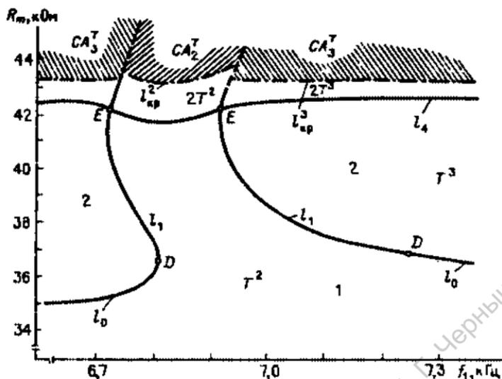
Рис. 13.13. Бифуркационная диаграмма режимов  $T^2$  и  $T^3$ . Физический эксперимент для  $f_1 = 8,97$  кГц,  $V_1 = 0,8$  В,  $V_2 = 0,15$  В
