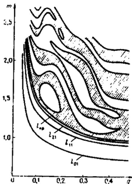
Рис. 8.1. Экспериментальная бифуркационная диаграмма режимов колебаний в генераторе:  $l_{k1}$  — линии удвоения,  $l_{кр}$  — линия критических значений параметров. Заштрихованные области соответствуют хаосу, незаштрихованные — отвечают многотактным устойчивым циклам
