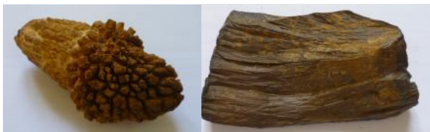
Рис. 4 Минерал лимонит, состав описывается формулой \text{Fe}_2\text{O}_3 \cdot n\text{H}_2\text{O} а - аморфная структура, б – кристаллическая структура
