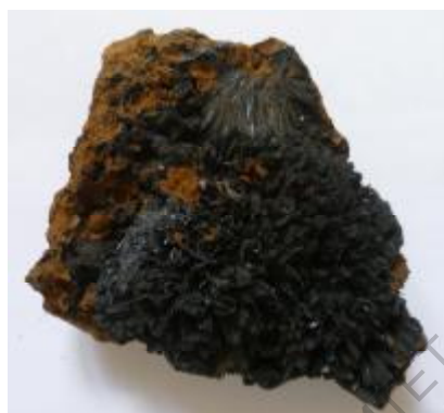
Рис. 5 Минерал кергинит (кальциоферрит) состава (\text{Ca}, \text{Mg})_3(\text{Fe}, \text{Al})_3[\text{PO}_4]_4(\text{OH})_3 \cdot 8\text{H}_2\text{O} , сформирован в виде «щетки» практически черного цвета.
