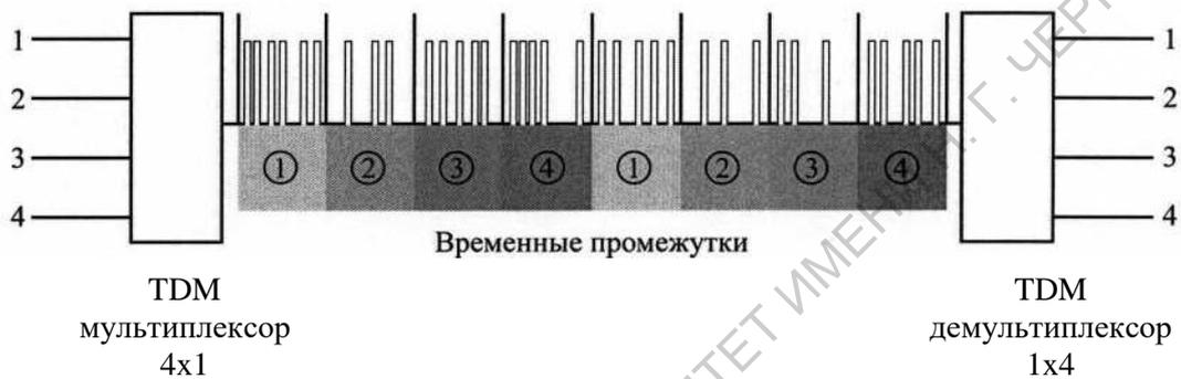
Рис.1 Схема временного разделения каналов в системе TDM.
