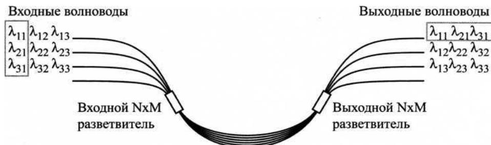
Рис. 23. Решетка на основе массива волноводов AWG - принцип работы
