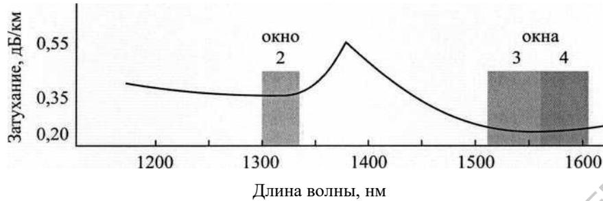
Рис. 13. Спектральная зависимость затухания в волокне TrueWave™ RS.
