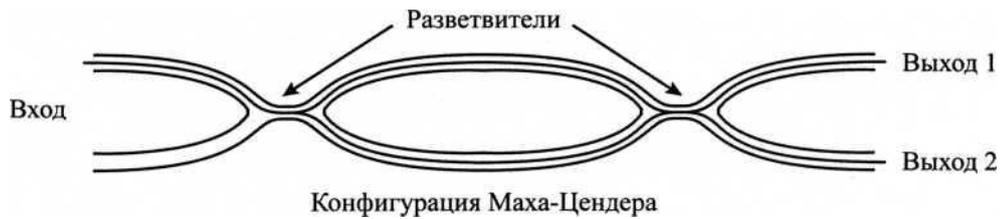
Рис. 24. Входной сигнал распределяется между двумя выходами.
