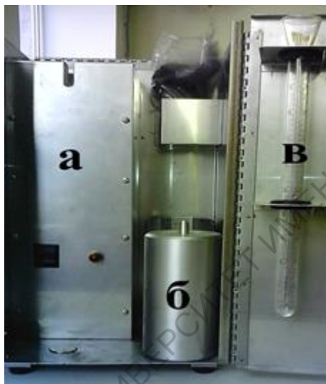
Рис.9. а - нагревательная камера; б - конденсатор; в - градуированный (измерительный) цилиндр.
