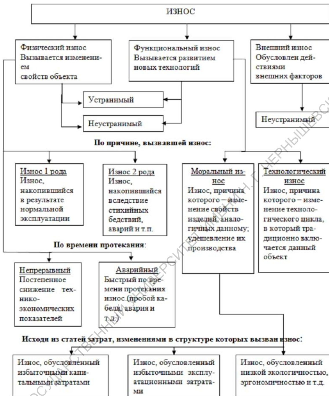
Рисунок 3 – Схема взаимосвязи видов износа.
