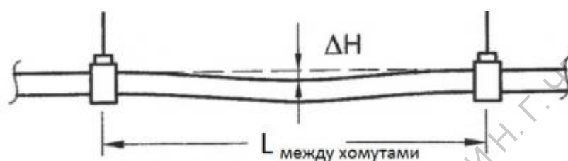
Рисунок 5 – Прогиб трубы в результате температурного удлинения.
