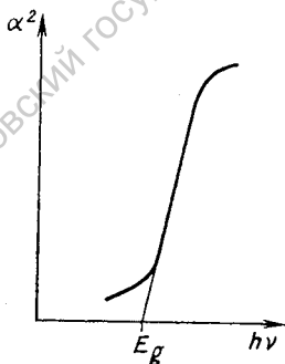
Рис. 11.4. Зависимость квадрата коэффициента поглощения при прямых разрешенных переходах от энергии
