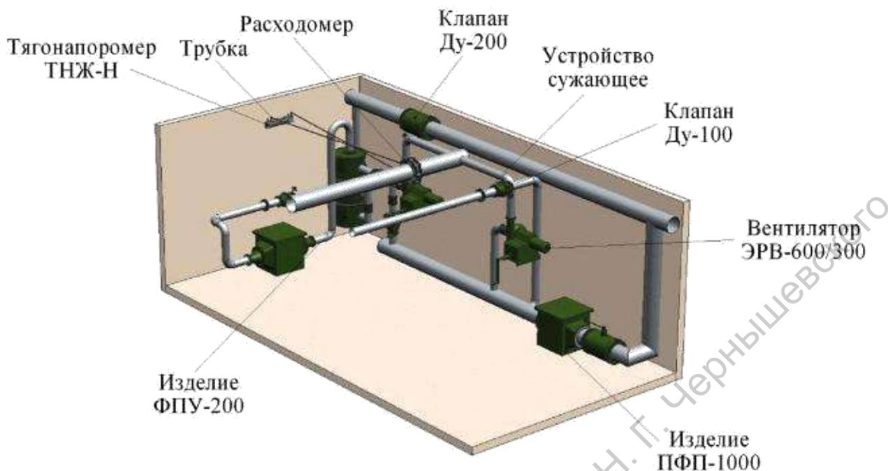
**Рис. 4.** Фильтровентиляционный комплект
