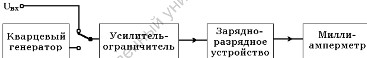
Рис. 2.2. Структурная схема конденсаторного частотомера.
