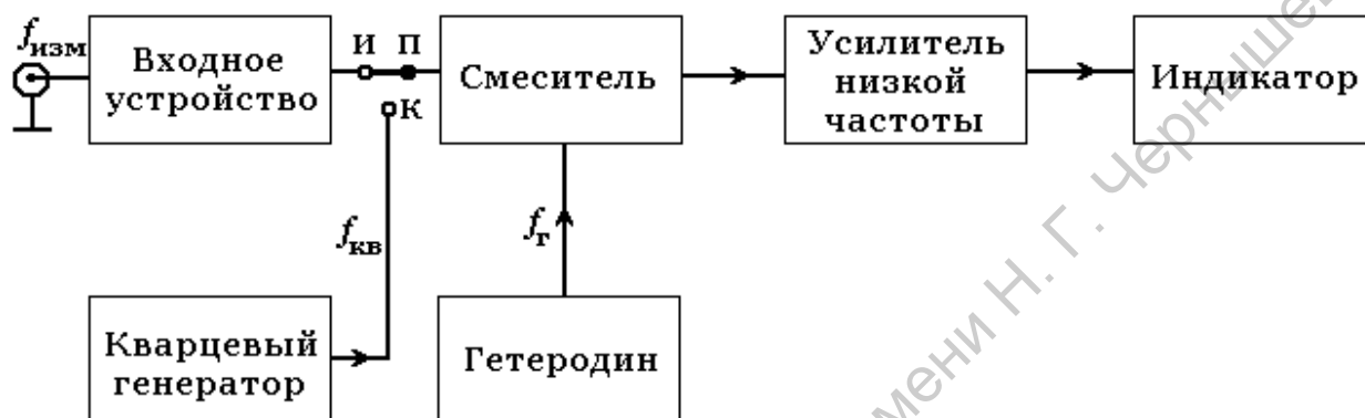
Рис. 2.3. Функциональная схема гетеродинного частотомера.
