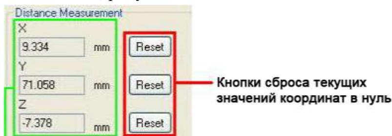
Рисунок 2.11. Фрагмент окна Stage Controller с координатами положения образца.
