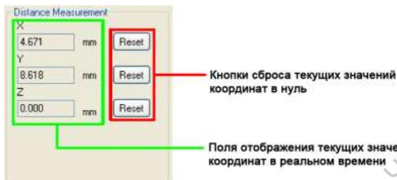
Рисунок 2.30 Группа элементов Distance Measurement окна Stage Controller
