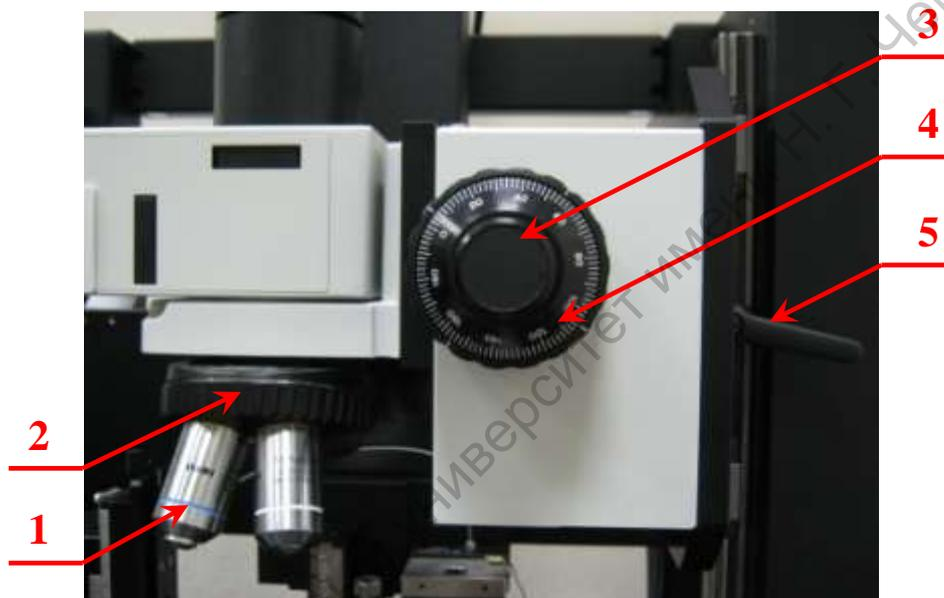
Рисунок 2.8. Оптический микроскоп, где: 1 – объективы микроскопа на 5x, 20x, 50x, 100x; 2 – поворотное кольцо смены объективов; 3 – ручка плавной регулировки фокуса; 4 – ручка грубой регулировки фокуса; 5 – ограничитель высоты микроскопа.
