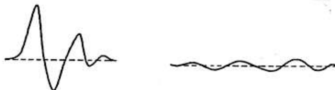
Рис.43 Деформация сейсмического импульса в модели сплошной упругой среды: а –вблизи источника, б-вдали от источника.
