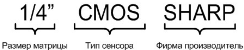
Рис. ЛЗ.1 Типичный светочувствительный элемент и его основные характеристики.
